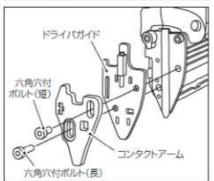
コンタクトアーム C ユニットをドライバ ガイドの上に重ねて取付け、六角穴付ボルト(短)、六角穴付ボルト(長)を六角棒スパナでしっかりと締めて下さい。
