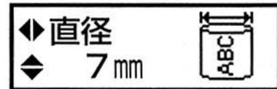
● ケーブルの直径を設定すると、自動的にケーブル外径2周分のラベル長に設定されます。
