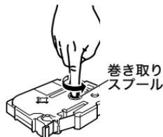
レタリテープをセットするときにインクリボンのたるみを取ってください。印刷したテープは絶対に引っ張り出さないでください。インクリボン飛び出しの原因になります。
