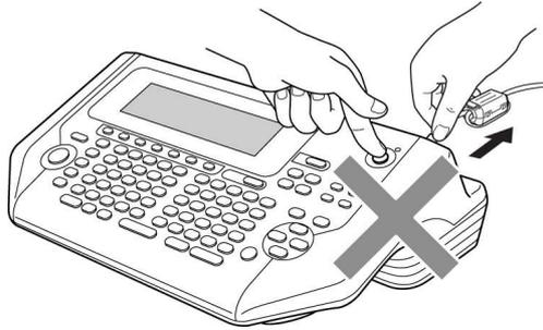
②接続コネクタ及び装着端子には手で直接触れないでください。静電気により故障の原因になります。
