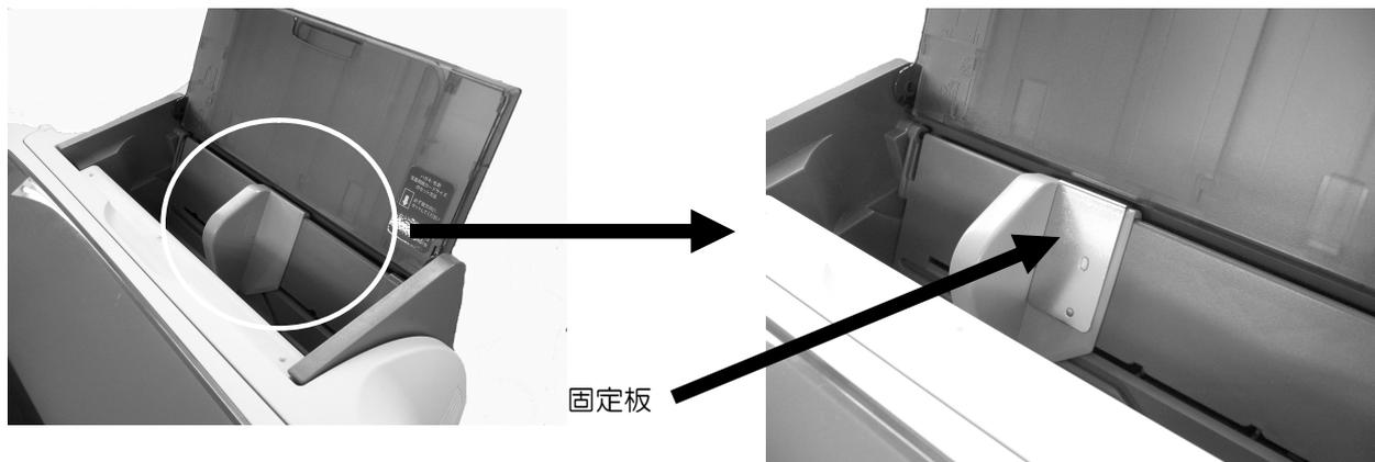
②固定板の位置合わせ穴にガイドの穴突起を合わせる事によりマグネットで固定されます。
