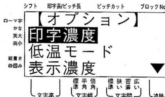
② 画面に【オプション】と表示し、「印字濃度」を反転表示しますので、**確定** キーを押します。
