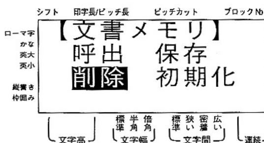
③画面が【文書削除】に変わりますので、**NUM** キーまたは **DEL** キーで文書番号を1桁ずつ増減するか、数字キーで直接入力して **ENTER** キーを押します。この時入力値の最後の桁を削除するには **BS** キーを、設定を初期化する (文書番号を1に戻す) には **DEL** キーを、メモリ操作を中止するには **ESC** キーを押します。
