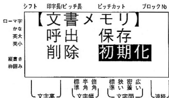
③【文書初期化】画面に変わり「しない」が反転表示していますので、内部メモリを初期化する場合の **初期化** キーで「する」を選び、**確定** キーを押します。文書初期化「しない」に戻すには **削除** キーを、メモリ操作を中止するには **取消** キーを押します。
