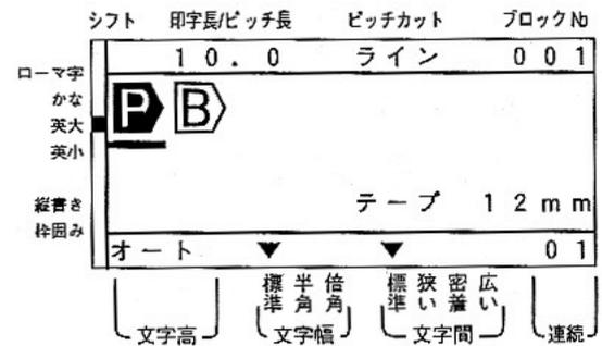
⑦ **ピッチ長** を押します。[3][0] と押して、「30mm」と表示されているのを確認し、**確定** を押します。
