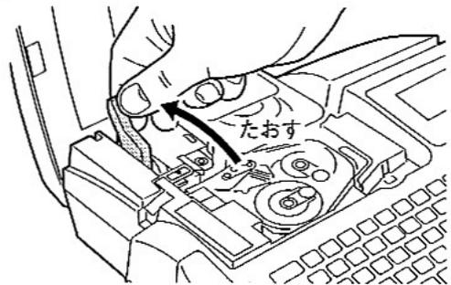
3. 最初にインクリボンカセットを外します。
