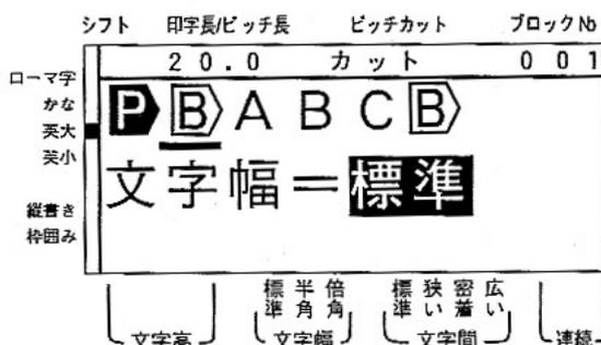
②設定画面に「文字幅」と表示し、右に現在の設定が反転表示しますので**Ⓚ**キーまたは**Ⓧ**キーで変更し、**確定**キーを押します。初期値(標準)に戻すには**解除**キーを、文字幅設定を中止するには**取消**キーを押します。
