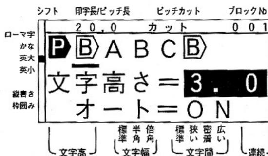
③ **⊞** キーで設定画面下段「オート」の「ON」が反転しますので、**K** キーまたは **⊞** キーで ON/OFFを切り換えます。
