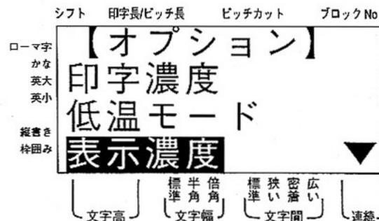
③画面が【表示濃度】に変わり、現在の設定を横棒グラフで表示しますので、**[K]** (薄くなる) または **[M]** (濃くなる) キーで調整し、**[確定]** キーを押します。初期値「4」に戻すには **[削除]** キーを、オプション選択画面に戻すには **[取消]** キーを押します。
