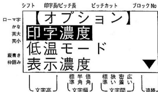
②画面に【オプション】と表示し「印字濃度」を反転表示しますので、**[V]** キーを2回押し「表示濃度」を反転し、**[確定]** キーを押します。
