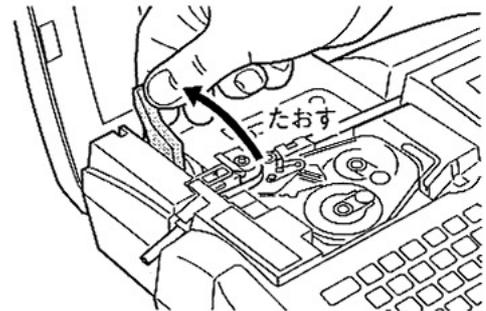
3. 最初にインクリボンカセットの2つの取り外しツメ部を持ち、インクリボンカセットを外します。
