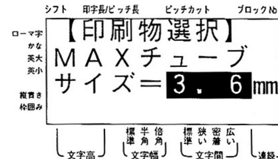
⑥ **[確定]** を押して、印刷物を確定します。
