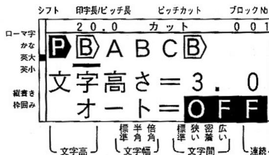
④ **確定** キーを押すと、設定が確定されます。また設定を初期値に戻す場合は **削除** キーを、文字高さ設定を中止するには **取消** キーを押します。
