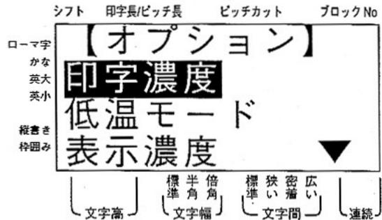
② **決定** キーを押して「低温モード」を反転表示し、**確定** キーを押します。
