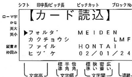
④読み込みたいファイルを選び、**確定**キーを押します。【文書カード】画面に戻すには**取消**キーを押します。
