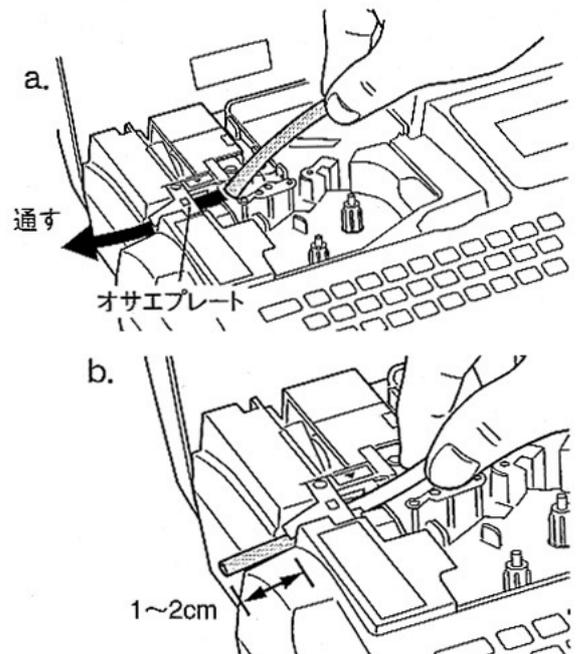
5. チューブが浮かないように、A 部付近を軽く押さえながら、銀色の切り替えレバーを図のように止まるまでスライドさせます。
