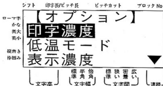
② 画面に【オプション】と表示し「印字濃度」を反転表示しますので、**上** キーを3回押して「6、9印字」を反転し **確定** キーを押します。
