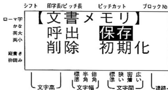
③ **△** または **▽** キーを押すと呼出／削除、保存／初期化を切換え、**Ⓚ** キーまたは **Ⓜ** キーを押すと呼出／保存／削除／初期化を切換えられます。ここでは **Ⓜ** キーを押して「呼出」を「保存」に切換えて **確定** を押します。
