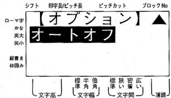
③画面が【オートオフ】に変わり、現在の設定を表示しますので**左向き矢印**または**右向き矢印** キーを押し、**確定** キーを押します。初期値「する」に戻すには**削除** キーを、オプション選択画面に戻すには**取消** キーを押します。
