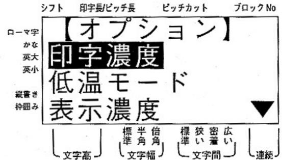
②画面に【オプション】と表示し「印字濃度」を反転表示しますので、**上向き矢印** キーを6回押し「オートオフ」を反転し、**確定** キーを押します。
