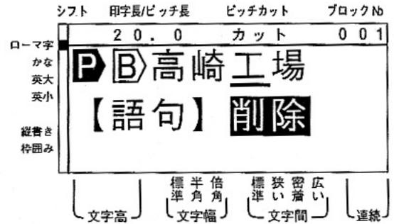
③画面の上下中央に「削除番号=」と表示して「1」を反転表示しますので、削除したい語句の番号を1～30の数字を直接キー入力するか **⏪** または **⏩** キーで選んで **確定** キーを押します。
