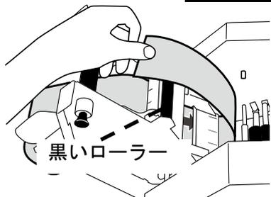
8. 剥離紙巻き取り軸のスリットに剥離紙を差込、黒いダイヤルを回して軸へ3周巻きつけ、外れないようにします。 **本体シール⑧**
