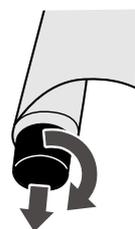
軸の凹部を奥に向けて、軸を時計回りに回転させると剥離紙が引き抜きやすくなります。
