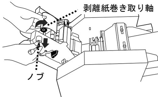
6. 剥離紙巻き取り軸から剥離紙を引き抜きます。
