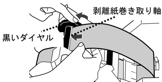
剥離紙巻き取り軸がセットされていないときは、次のようにセットして下さい。
