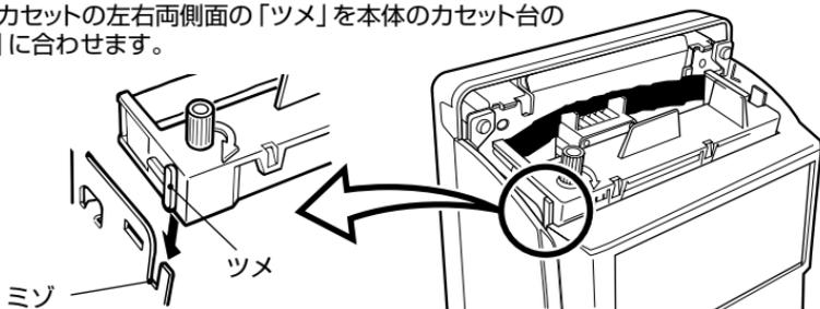
5. リボンカセットの「つまみ」を回しながら、「リボン」が「プリンタヘッド」と「マスク板」の間になるよう、カチッと音がするまで押しつける。
