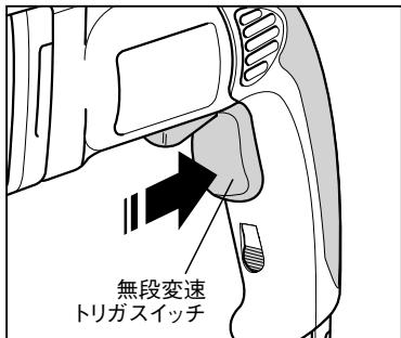
トリガスイッチを引くと作動します。またトリガスイッチを放せば止まります。トリガスイッチには無段变速機能が組み込まれていますので、強く引くと高速、弱く引くと低速というように速度を調節できます。作業の内容によってトリガの引き具合で速度を調節できるので大変便利です。
