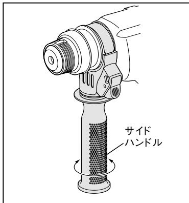
本機に備え付けのサイドハンドルは、360度の自由な角度に設定することが可能です。サイドハンドルを緩めて作業に一番合う角度に調節し、希望角度に調節した上で、サイドハンドルを締めてください。
