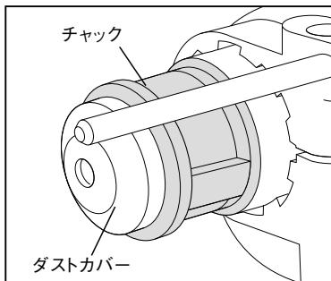
ダストカバーはホコリが本機内部に入るのを防いでいます。ダストカバーは摩耗したら直ちに交換してください。
