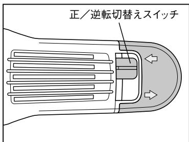
正／逆転切替えスイッチを図の上側にスライドさせると正転します。正／逆転切替えスイッチを図の下側にスライドさせると逆転します。
