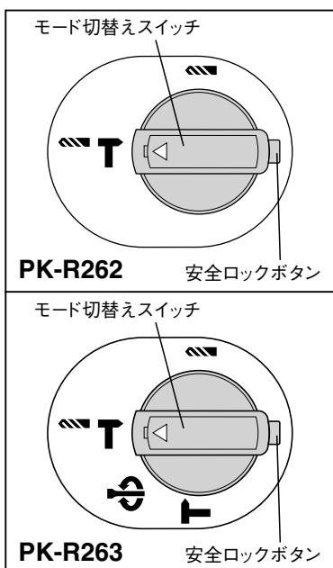
木工／鉄工の穴あけ、乾式ダイヤモンドコアドリルでのコンクリートへのコア抜き作業には“
