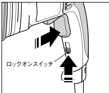
トリガスイッチを引いた状態でロックオンスイッチを上に上げると、トリガスイッチがロックされ継続的に使用されるときに便利です。ロックを解除するには、トリガスイッチをもう一度軽く引いてください。
