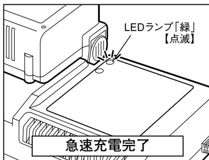
急速充電が完了したら使用できますが、そのまま電池パックを抜かないでくと、残りの容量を充電し続け、LEDランプ「緑」が点灯（電子ブザーが「ピー」と約2秒鳴ります）になれば満充電完了（容量の100%）です。
