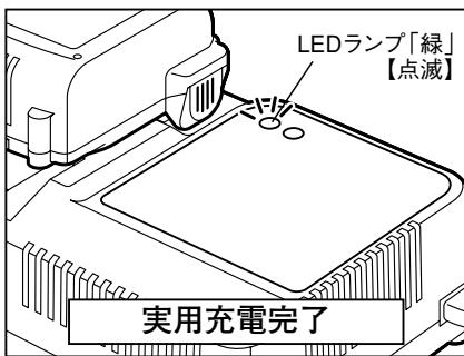
実用充電が完了したら使用できますが、そのまま電池パックを抜かないでおくと、残りの容量を充電し続け、LEDランプ「緑」が点灯（電子ブザーが「ピー」と約2秒鳴ります）になれば満充電完了（容量の約100%）です。
