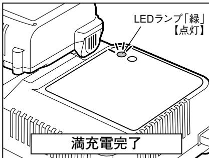
**④充電が完了したら電池パックを充電器から抜き取ってください。**
