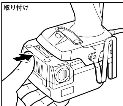
電池パックを本機から取り外すときは、左右両側にあるラッチを押して、矢印方向にまっすぐ電池パックをスライドして取り外してください。
