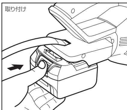
電池パックを本機から取り外すときは、後側にあるストッパを押して、矢印方向にまっすぐ電池パックをスライドして取り外してください。
