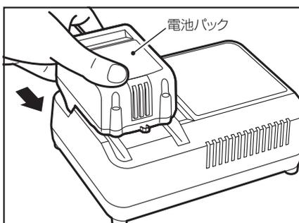
2. 電池パックを充電器にセットすると、自動的に充電を開始します。LEDランプ「赤」が点灯し、電子ブザーが1回「ピ」と鳴り、充電中をお知らせします。
