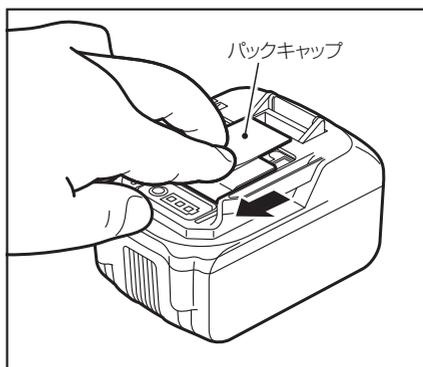
一度使用されて電池パックを本機に取付けている場合は、本機より電池パックを取外します。
