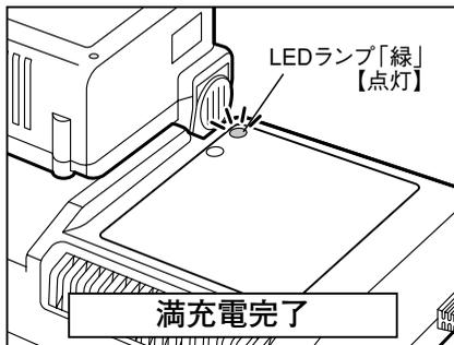
④ 充電が完了したら電池パックを充電器から抜き取ってください。
