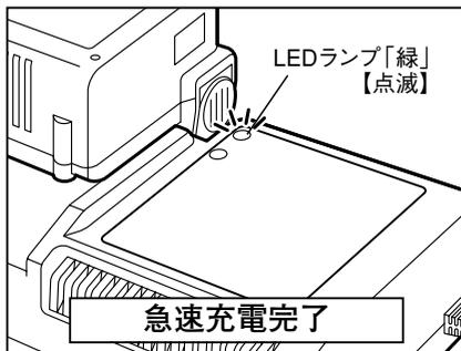
急速充電が完了したら使用できますが、そのまま電池パックを抜かないでないと、残りの容量を充電し続け、LEDランプ「緑」が点灯(電子ブザーが「ピー」と約2秒鳴ります)になれば満充電完了(容量の100%)です。
