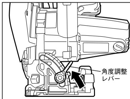
**④** ベースが斜めに傾いた状態で、①ベース後部のレベルストッパーピンを奥まで押し込み、②ベースを図の矢印の方向に突き当たるまで傾けます。
