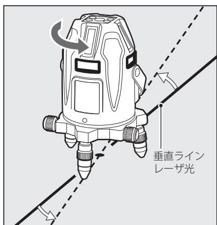
この時、微調整ダイヤルを使用すると簡単に確実に合わせることができます。
