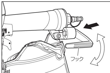
フックは反対側に取り付けることができます。付け変えるときは、六角棒スパナでボルトをはずし、フックの取付け位置を変えてから、再び組込んでください。
