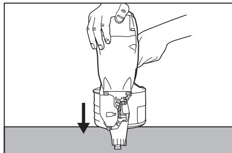
図のようにコンタクトアーム先端が飛び出した状態が正常です。そうでない場合は③からやり直してください。
