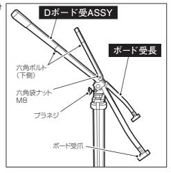
④プラネジM8×35を締め込み、本体 シリンダパイプジョイント部と先端 ブラケットをしっかり固定してください。
