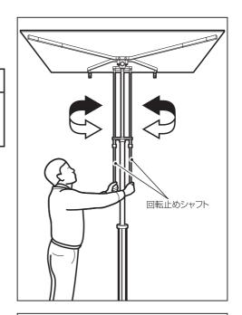
ボードの取付け作業(釘打作業、ネジ締め 作業) が終ったら、操作バルブユニットの 下降ボタンを押してリフタを下げてくだ さい。又、下降途中でリフタを停止する 必要がある場合は、下降ボタンを離せば 停止します。
