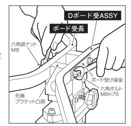
この時、ボード受長とボード受の取り付け 位置を間違わない様注意してください。 Dボード受1とDボード受2を取り付けた 六角ボルトが下側にくるようにしてくだ さい。
