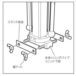
②次にスタンドフレーム2本をそれぞれ シリンダパイプユニット下部の植込み ボルトに嵌め込み、スタンド座金を乗せ、 蝶ナットを締め込み、しっかり固定して ください。
