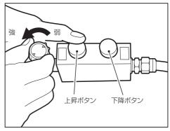
位置決めノブが下プレートに押し付けられ たところで上昇ボタンを離してください。 この時天井材が天井下地に押し付けられる ほど上昇したり、逆に天井材が天井下地に 届かず隙間があく場合は、押し上げ高さの 設定 (P12) を行ってください。
