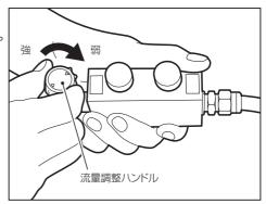
操作バルブユニットの上昇ボタンを押しながら、流量調整ハンドルを反時計方向に回し、ボードの押し上げスピードを調整してください。ボードの厚みや大きさによって重さが変わるとスピードも変化します。途中で停止させる場合は上昇ボタンを離せばその位置で停止します。
