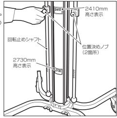
天井材が天井下地に押し付けられるほど 上昇する場合は、位置決めノブを上の 微調整穴に合わせてください。 逆に天井材が天井下地に届かずに隙間が あく場合は、位置決めノブを下の微調整穴 に合わせてください。
