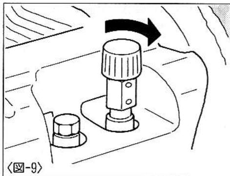
②圧力が上昇して運転が停止しましたら、減圧弁調整ハンドルを回して空気工具の適正な使用圧力に調整を行ないます。圧力の調整方法は、減圧弁調整ハンドルを左に回し、適正な圧力より2kgf/cm<sup>2</sup>以下に一旦減圧を行ないます。次に減圧弁調整ハンドルを右に回し、圧力を上げて調整を行なってください。〈図-10〉
