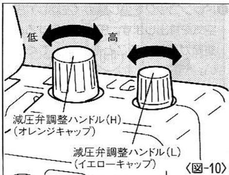
※圧力を調整する際は、必ず適正圧力より低い圧力から圧力を上げて調整してください。適正な圧力より高い圧力から減圧を行ない調整すると、圧力ゲージと実際の使用圧力に約3kgf/cm<sup>2</sup>程度の誤差が生じます。(減圧弁の特性)
