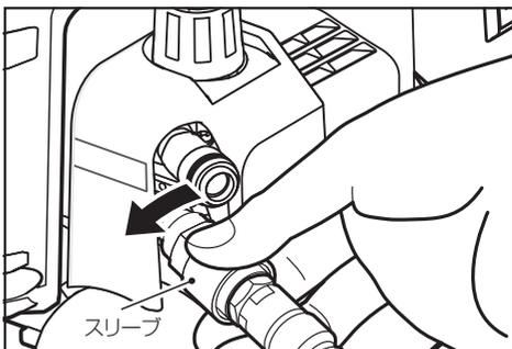
②エアチャックのスリーブを本機側に押し込むことで取り外しできます。
