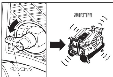
⑨ドレンコックを閉じて圧縮運転中に電源を切り(OFFにして)運転が停止することを確認してください。
