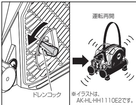
⑩ドレンコックを閉じて圧縮運転中に電源を切り(OFFにして) 運転が停止することを確認してください。
