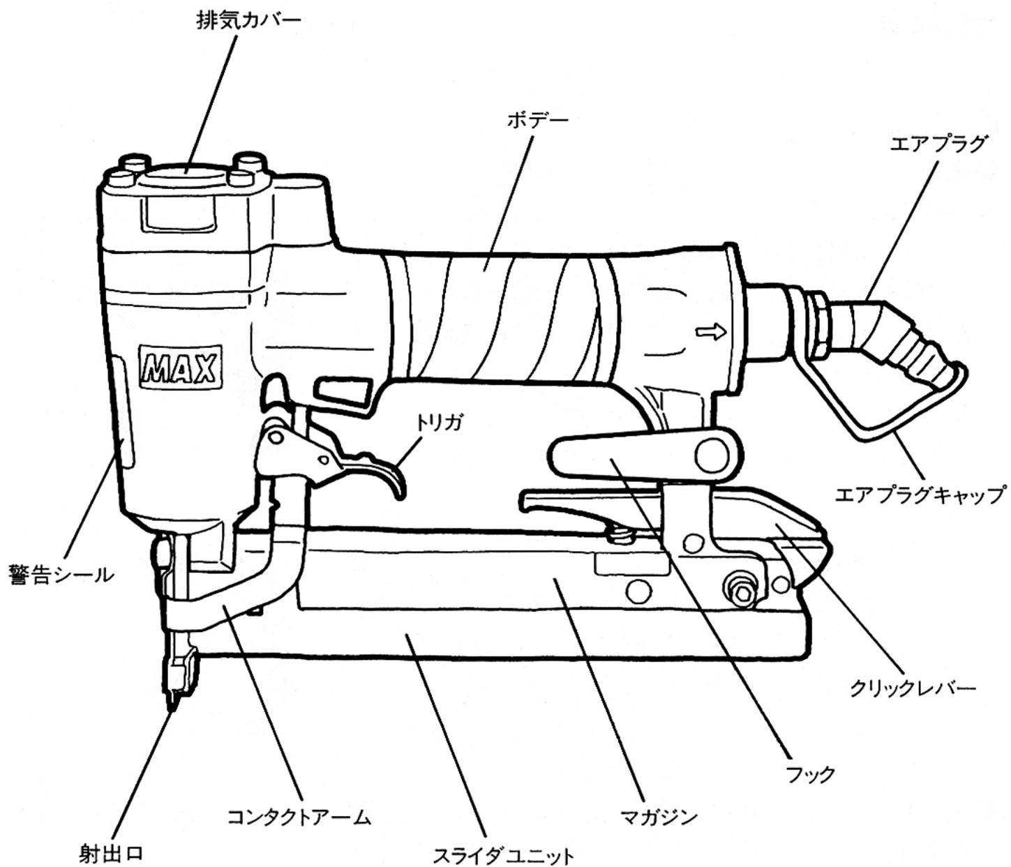
本機は、木材およびそれに類した材料、石膏ボードなどにステープルを打ち込むことを目的とした釘打機です。指定以外の用途、使用方法は重大な事故につながる恐れがあります。この取扱説明書の記載事項を厳守してください。作業関係者以外、特に子供は作業場所に近づけないでください。また、本機に触らせないでください。
