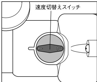
速度切替えスイッチにより、本機の回転数を2段階に設定することができます。切替えスイッチを1に設定すると低速、2に設定すると高速にて作業することができます。速度切替えスイッチを切替えるには、無段変速トリガスイッチから手を放し、モータの回転が停止してから作業用途に合った回転数に設定してください。
