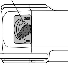
金工／木工穴あけ作業にはモード切替えスイッチを“”の位置にセットしてください。コンクリートへの穴あけ作業には、モード切替えスイッチを“”の位置にセットしてください。
