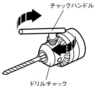
付属のチャックハンドルをドリルチャック上にあいている3ヶ所いずれかの穴に入れ、反時計回りにまわしてアクセサリー挿入口を緩めてください。ドリルチャックに先端工具を奥まで差し込んでください。チャックハンドルをドリルチャック上にあいている3ヶ所の穴に順々に入れ、時計回りにまわして軽く締め付けていきます。最後に3ヶ所とも均等の力でしっかりと締めてください。
