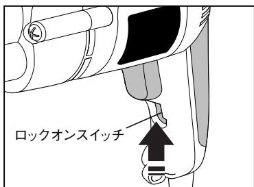
無段变速トリガスイッチを引いた状態でロックオンスイッチを上に上げると、無段变速トリガスイッチがロックされ継続的に使用されるときに便利です。ロックを解除するには、無段变速トリガスイッチをもう一度軽く引いてください。
