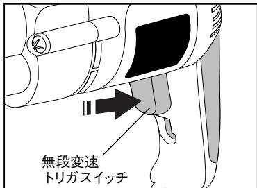
無段变速トリガスイッチを引くと作動します。また無段变速トリガスイッチを放せば止まります。トリガスイッチには無段变速機能が組み込まれていますので、強く引くと高速、弱く引くと低速というように速度を調節できます。作業の内容によって無段变速トリガスイッチの引き具合で速度を調節できるので大変便利です。
