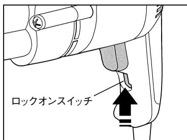
無段変速トリガスイッチを引いた状態でロックオンスイッチを上上げると、無段変速トリガスイッチがロックされ継続的に使用されるときに便利です。ロックを解除するには、無段変速トリガスイッチをもう一度軽く引いてください。
