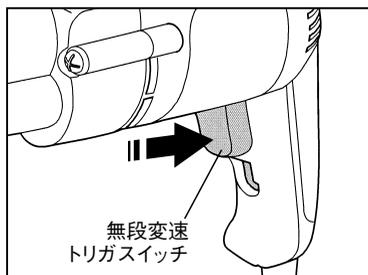
無段変速トリガスイッチを引くと作動します。また無段変速トリガスイッチを放せば止まります。トリガスイッチには無段変速機能が組み込まれていますので、強く引くと高速、弱く引くと低速というように速度を調節できます。作業の内容によって無段変速トリガスイッチの引き具合で速度を調節できるので大変便利です。
