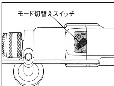
金工／木工穴あけ作業にはモード切替えスイッチを“〰️”の位置にセットしてください。コンクリートへの穴あけ作業には、モード切替えスイッチを“◻️”の位置にセットしてください。
