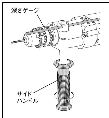
サイドハンドルの握りの部分を緩めた後、本機の首部から差し込んでください。作業に合った角度に合わせて、握り部分をしっかりと締め付けてください。深さゲージはサイドハンドルの握り部分を緩めると自由に動きますので、適切な深度に調節してご使用ください。
