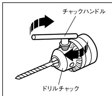
付属のチャックハンドルをドリルチャック上にあいている3ヶ所いずれかの穴に入れ、反時計廻りにまわしてアクセサリ挿入口を緩めてください。ドリルチャックに先端工具を奥まで差し込んでください。チャックハンドルをドリルチャック上にあいている3ヶ所の穴に順々に入れ、時計廻りにまわして軽く締め付けていきます。最後に3ヶ所とも均等の力でしっかりと締め付けてください。
