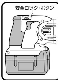
このレシプロソーのスイッチには安全ロック・ボタンが付いています。図にあるよう、安全ロック・ボタンをかけてください。この工具を持ち運ぶ際や保管する際、急に作動して事故を引き起こすのを防止するため、必ず安全ロック・ボタンをかけた状態にしてください。
