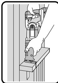
ソー・ブレードを従来の逆向きに装着することにより床や隅、困難な角度等も切断作業が容易に可能です。
