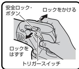
図にあるよう、安全ロック・ボタンを解除してください。トリガースイッチを引くとモーターに電源が入ります。トリガースイッチをはなすと電源が切れます。トリガースイッチには無段変速機能が組み込まれていますので、強く引くと高速、弱く引くと低速と速度を調節することが可能です。作業の用途により、引き金の引き具合で速度を調節できますので、大変便利です。
