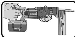
木材が固定されていないときは、切断作業の前にならずクランプ等を使って加工する物を固定してください。まずソー・ブレードをゆっくりと加工物へおろし、モーターのスイッチをゆっくり入れ、切断を開始する前に速度を最大まで上げてください。切断作業の最中はかならず両手を使ってレスプロソーをしっかりと固定してください。振動やぶれを防止するため、ブレード・ガードは作業物に常に接触した状態を保ってください。ソー・ブレードの破損防止にもつながります。
