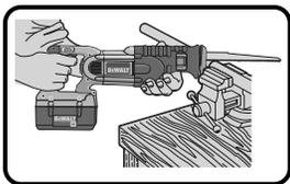
ソー・ブレードの種類により、金属の切断能力は異なります。ソー・ブレードを選ばれるとき製品の仕様、用途をよく読み、作業の内容に適したブレードをお選びください。通常、歯数が多いブレードの方がきれいに仕上がります。薄い金属板を切断される際、金属板の両面を木材ではさみ、クランプで固定することをお勧めします。この方が振動や金属切断部のまくれを防止し、きれいに仕上がります。切断作業中、無理な力をかけて切断することはソー・ブレードの寿命を著しく短縮させますのでおやめください。
