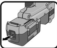
充電電池を工具から取り外すとき、充電電池についているリリース・ボタンを押し、充電電池を矢印の方向にスライドさせると工具から外れます。
