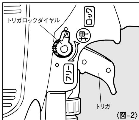
ネイルを打っているとき以外はトリガロックダイヤルを押し回し、ロックの位置にセットしエアホースをはずしてください。作業を始める場合はトリガロックダイヤルを押し回しフリーの位置にセットしてください。
