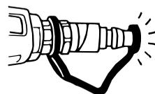
**⑥エアコンプレッサのタンク、補助タンク、エアセットのエアフィルタの水抜きをする**
