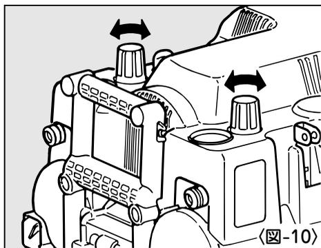
※ 圧力を調整する際は、必ず適正圧力より低い圧力から圧力を上げて調整してください。適正な圧力より高い圧力から減圧を行ない調整すると、圧力ゲージと実際の使用圧力に誤差が生じます。(減圧弁の特性)
