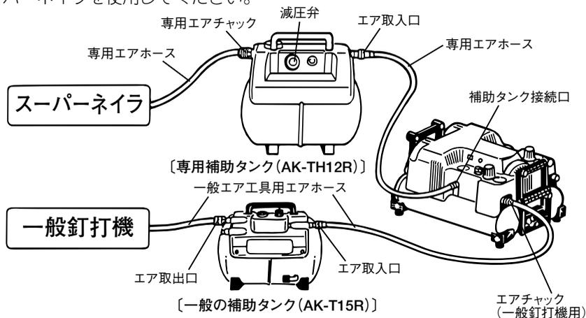
〈一般釘打機・エア工具を使用する場合〉
