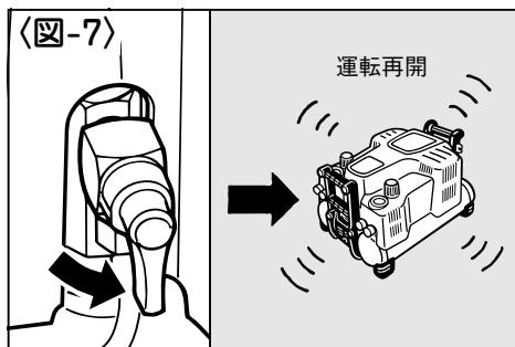
⑨ドレンコックを締めて圧縮運転中に電源を切り（OFFにして）運転が停止することを確認してください。
