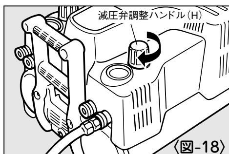
③エアタンク内に圧縮空気を充填し、専用補助タンクの減圧弁にて、エア工具の適正な使用圧力に調整します。
