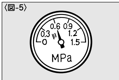
⑥4～7分程度で自動的に圧縮運転が停止することを確認してください。（補助タンク接続時、電圧降下時〈20ページ参照〉は運転時間が長くなる関係でこの場合は除きます。）
