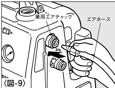
※エアチャックはワンタッチ式になっており、接続の際は、エアプラグを押し込むだけで接続ができます。
