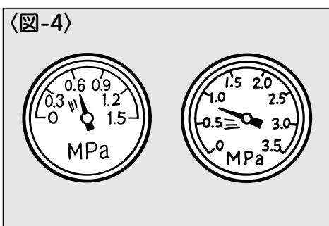
⑧2~3分程度で自動的に圧縮運転が停止することを確認してください。(補助タンク接続時、電圧降下時 <21ページ参照> は運転時間が長くなる関係でこの場合は除きます。)
