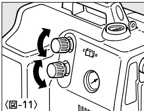
※圧力を調整する際は、必ず適正圧力より低い圧力から圧力を上げて調整してください。
