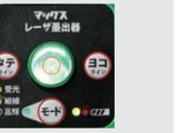
気泡管で合わせておくと、より短時間で整準可能。
