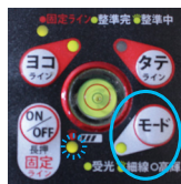
電子整準タイプ 2面に取り付けられた傾斜センサーで傾きを検知し、2つのモーターで制御します。
