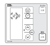
(確定がタン)を押すと表示が消え「 12 」が点滅表示されます。
