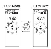
タイマー運転中に (銀) (エリアA / B切換えボタン)を押すと、液晶表示部の内容が「エリア / A / 」と「エリア / B / 」で切換わります。 どちらか一方しか設定していない場合は切換わりません。
