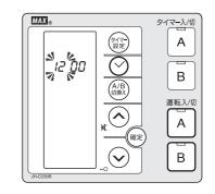
(確定ボタン)を押すと表示が消え「 **/** 」が点滅表示されます。
