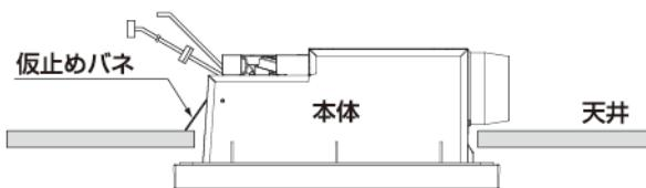
※排気ダクト接続口を設計プランにあうように、暖房機本体とフロントパネルを180°回転させて取付けることができます。
