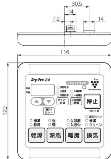
※開口寸法  $\phi$ 55(壁取付)
