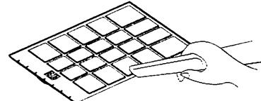
④副吸込グリルフロント内にフィルターをセットし、副吸込グリルジョイントの凹部と副吸込グリルフロントの凸部が合う方向で取り付けてください。
