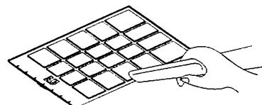
④副吸込グリルフロント内にフィルターをセットし、副吸込グリルジョイントの凹部と副吸込グリルフロントの凸部が合う方向で取り付けてください。
