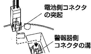
図のように電池側コネクタの突起と警報器側電池コネクタの溝をあわせて、しっかりと接続し電池収納部に電池を納めます。
