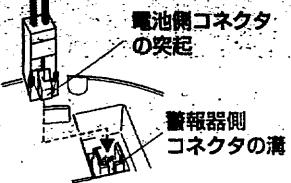
図のように電池側コネクタの突起と警報器側電池コネクタの溝をあわせて、しっかりと接続し電池収納部に電池を納めます。
