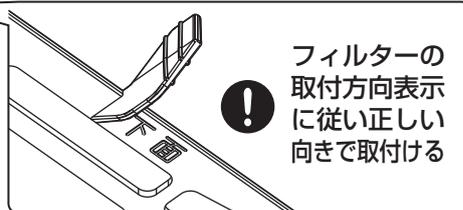
**!** フィルターの取付方向表示に従い正しい向きで取付ける
