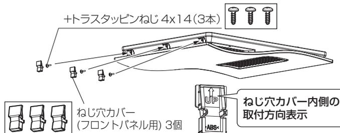
**!** フロントパネルは付属のねじ3本で確実に固定し付属のねじ穴カバー3個を必ず取付ける
