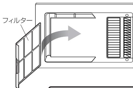
フィルターには表面、裏面があります。下図を参照し、正しい向きで取付けてください。
