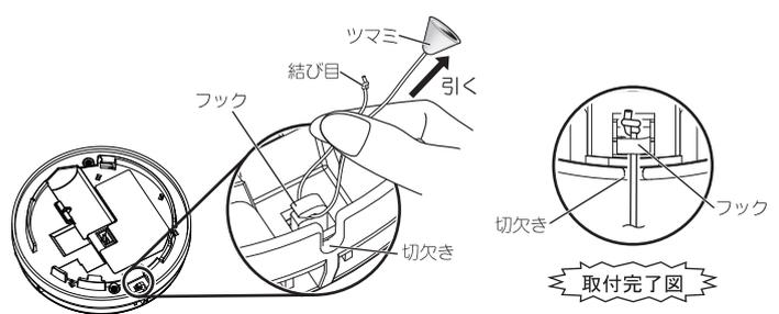
●引きひもを取り付けた後は、数回引きひもを引き、正常に操作できることを必ず確認してください。
