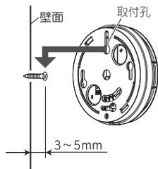
警報器を取り付けた後は、必ず正常に動作することを確認してください。4. 定期点検（テスト）のしかたを参照ください。
