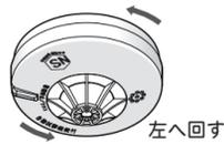
(2) 専用リチウム電池を取り付ける
