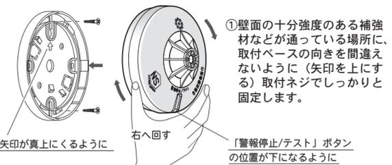
①壁面の十分強度のある補強材などが通っている場所に、取付ベースの向きを間違えないように（矢印を上にする）取付ネジでしっかりと固定します。
