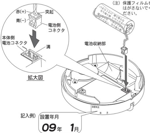
②本体の裏面にある電池収納部に電池を納めてください。このとき、電線を電池と収納部の間に挟まないでください。本体が取付ベースに取り付けられなくなります。
