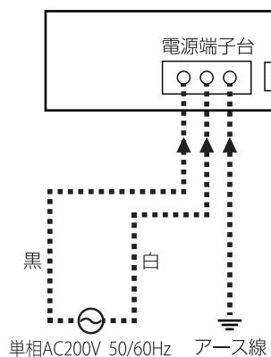
(注)ブレーカーを入れる前に必ず指定電圧「AC200V」が接続
