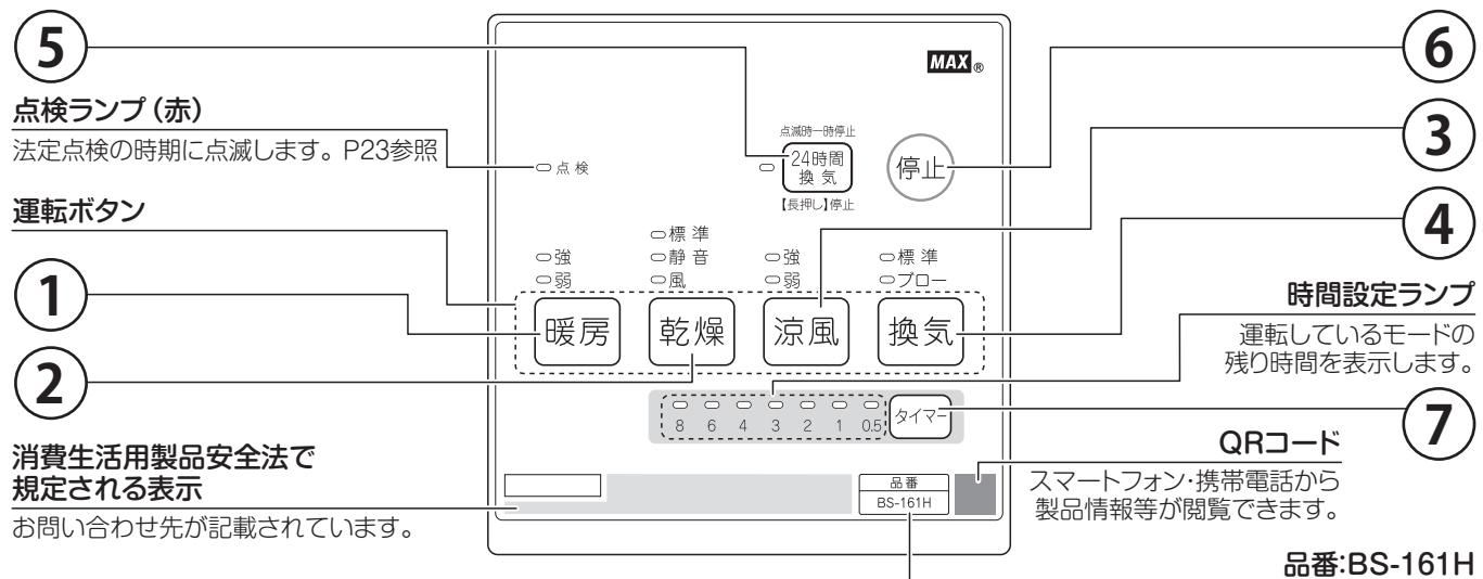
リモコンを操作するときは、目的に合わせて正確にボタンを押し、ランプの点灯(緑)を確認してください。
