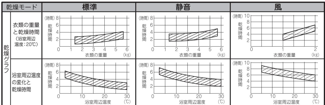
※乾燥時間は目安です。季節、室温、浴室の大きさ・材質・形状、浴室内の乾燥状態、洗濯物の種類、脱水状態、洗濯物を吊るす位置などによって変化し、乾きにくい場合があります。
