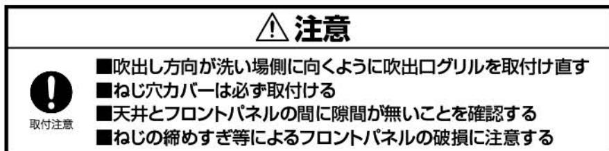
ダクト取付け工事および電気工事は別途工事となります。
