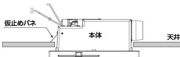
※排気ダクト接続口を設計プランにあうように、暖房機本体とフロントパネルを180°回転させて取付けることができます。
