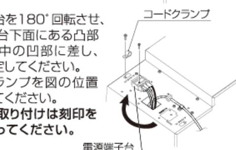
**!** 電源端子台およびコードクランプ取付位置には刻印が記されています。正しい位置に固定してください。
