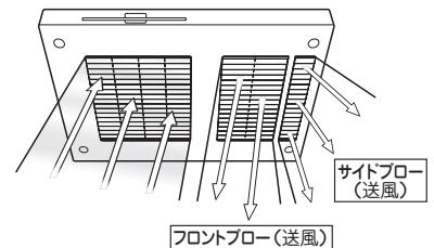
設定した入時刻になると、毎日クリーン換気運転を開始します。フロント吹出口とサイド吹出口から風が吹出します。
