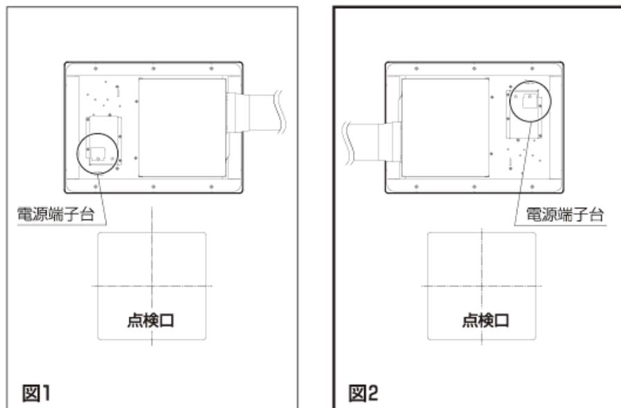
図2のような場合、下記の手順を参照し、電源端子台を取り付け直してください。
