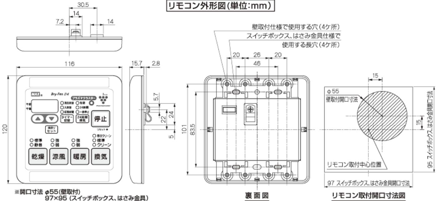
※開口寸法  $\phi 55$ (壁取付)
