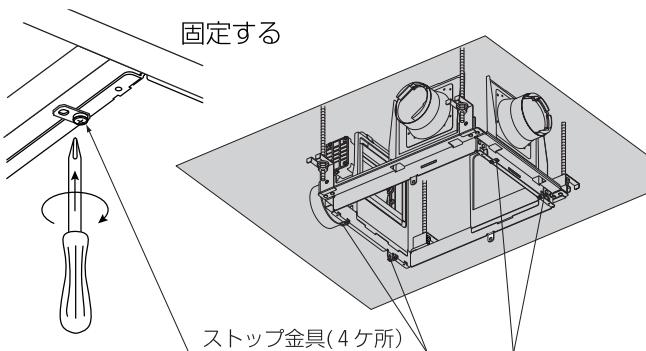
天井面と取付枠下側のフランジ部の位置を合わせダブルナットで確実に固定してください。
