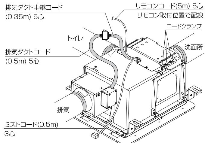
②リモコンコードをリモコン取付位置まで配線してください。リモコンコード先端のコネクタを保護し、コードの心線に無理がかからないように注意してください。
