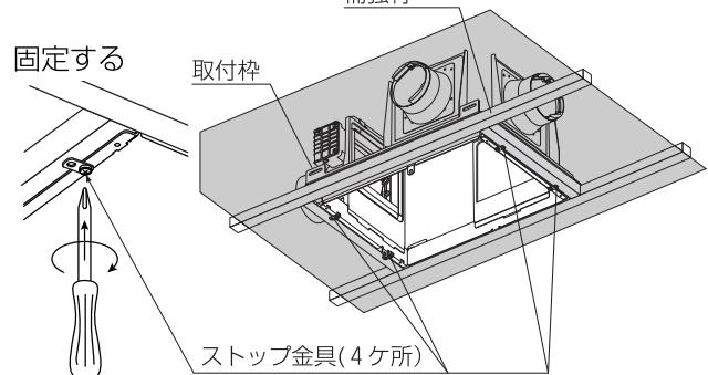
[注意]ストップ金具は、本体取り付けの際、取付枠が天井開口部の奥へ逃げてしまうのを防ぐためのものです。しっかり固定してください。
