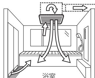
浴室室内空気を循環させながら排気を行う運転をした後、仕上げに浮遊カビ菌を除去するプラズマクラスターイオンを浴室室内に循環させます。
