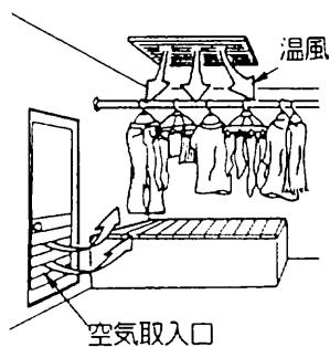
浴室を衣類乾燥機にして、洗濯物を吊して乾燥します。
